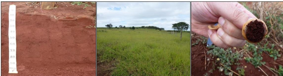
Apêndice 2.3.3E. (A) Corte de barranco expõe Latossolo Vermelho Férrico Típico. Encontrado no topo da mesa basáltica, em terreno de pasto com brachiária (B). (C) Detalhe de aferição do caráter férrico do solo com utilização de imã.
